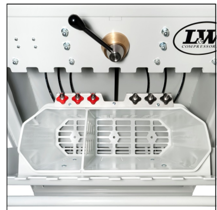
3 x 200 bar und 3 x 300 bar Füllanschlüsse in Füllbox
