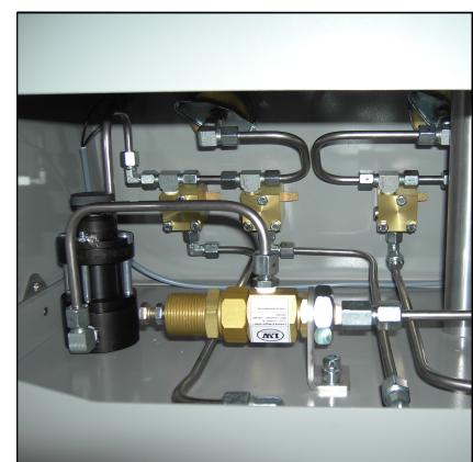
Abb. links Sicherheitsventil: 225 bar, rechts Druckminderer: 330 / 225 bar
