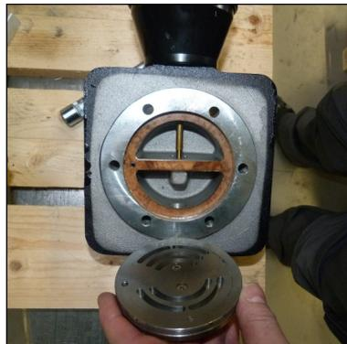
Abb. 2 - Saug- und Druckventil entnehmen
