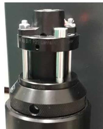
Abb. 3 - Sicherheitsventil 3. Stufe
