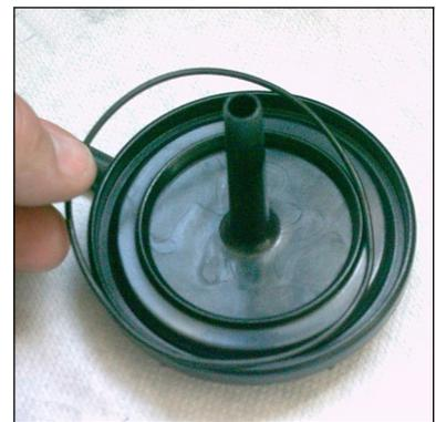
Abb. 3 - O-Ring in Gehäusedeckel einlegen
