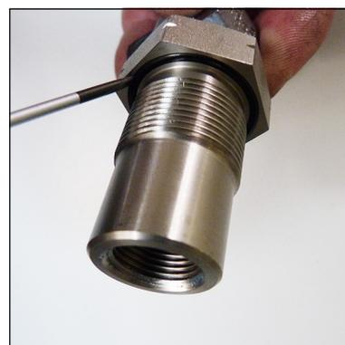
Abb. 4 - O-Ring wechseln
