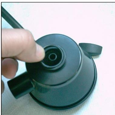
Abb. 4 - O-Ring in Zentrierbund einlegen
