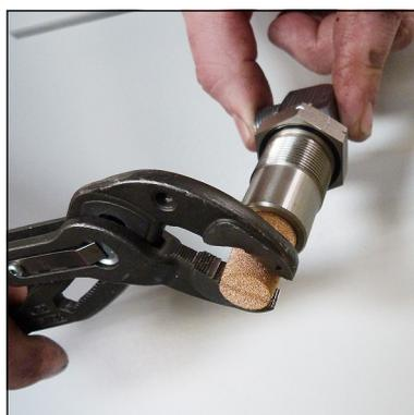
Abb. 3 - Sinterfilter wechseln
