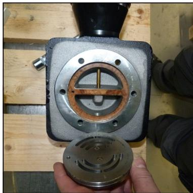
Abb. 2 - Auf korrekte Platzierung der oberen Dichtung achten!
