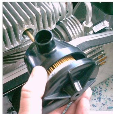
Abb. 2 - Filtergehäuse vorsichtig herausziehen
