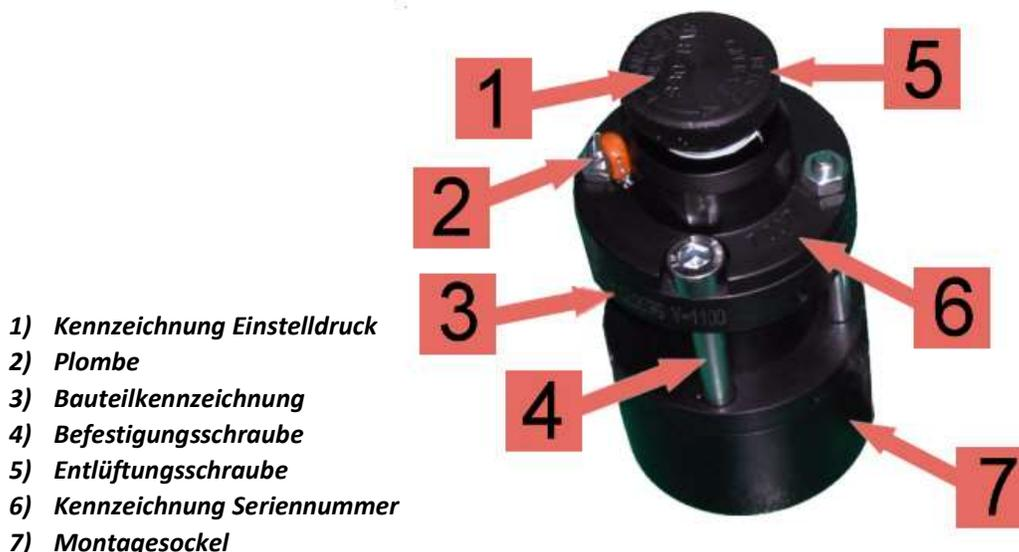
Um ein Verstellen des Einstelldrucks zu verhindern, werden sämtliche Sicherheitsventile ab Werk mit einer Plombe versehen; die Plombe ist mit TÜV HE gekennzeichnet.
