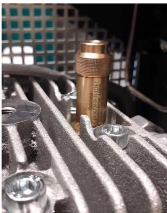
Abb. 1 - Sicherheitsventil 1. Stufe
