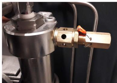
Abb. 2 - Sicherheitsventil 2. Stufe
