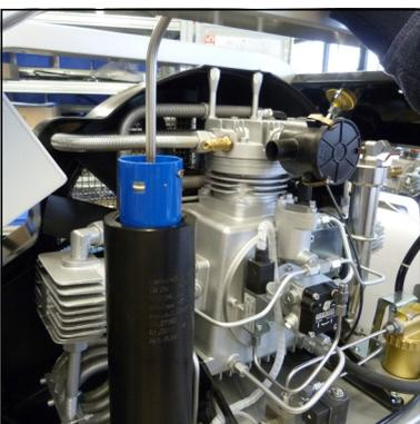
Abb. 2 - Filterpatrone mit Filterschlüssel entnehmen
