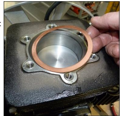
Abb. 1 - Untere Ventildichtung
