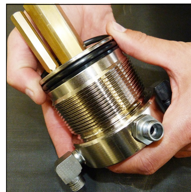
Abb. 4 - O-Ring und Stützring wechseln
