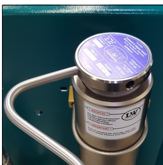
Abb. 2 - Abschrauben des Filtergehäuse-Deckels
