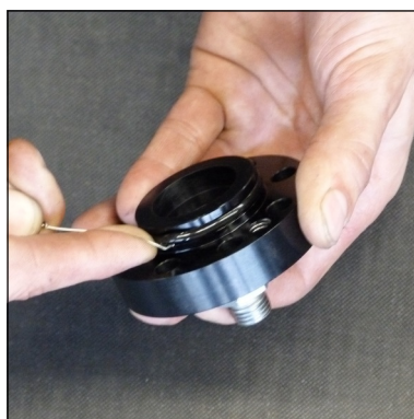
Abb. 4 - O-Ring wechseln (Deckel Kondensat-Stopp-Ventil)
