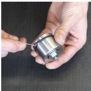
Abb. 4 - O-Ring wechseln am Kondensat-Stopp-Ventil
