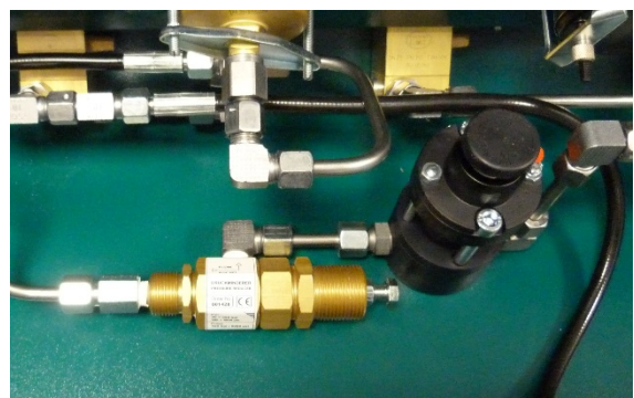
Abb. (li.) Druckminderer; (re) Sicherheitsventil
